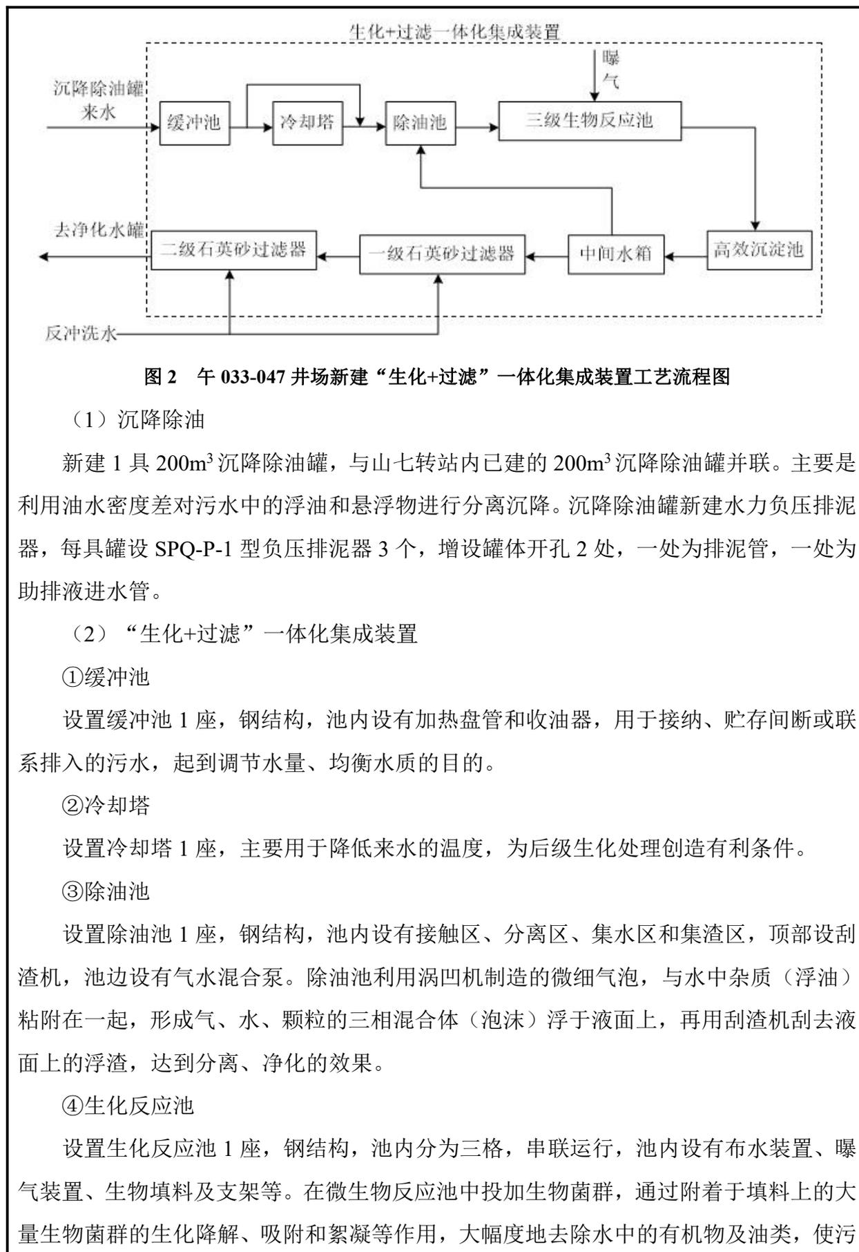
图2 午033-047井场新建“生化+过滤”一体化集成装置工艺流程图
